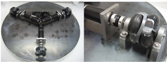
그림 9. 전방향 이동 로봇의 바퀴 Fig. 9. Omni wheels
